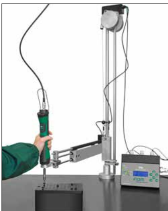
Kartesische Werkzeughalter mit Vorrichtung zur Positionserkennung
