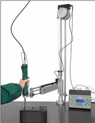
Kartesischer Werkzeughalter mit Vorrichtung zur Positionserkennung
