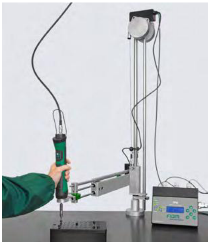
Werkzeughalter mit Vorrichtung zur Positionserkennung
