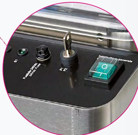
Wahlschalter zur Auswahl, ob mit Drehmomentsteuerung oder Schraubenhöhenregelung gearbeitet werden soll
