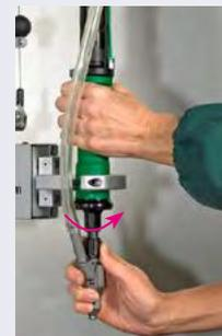
**Kopfdrehung um 360°:** in 6 verschiedene Positionen, einstellbar entsprechend der Abmessungen an der Verschraubungsstelle
