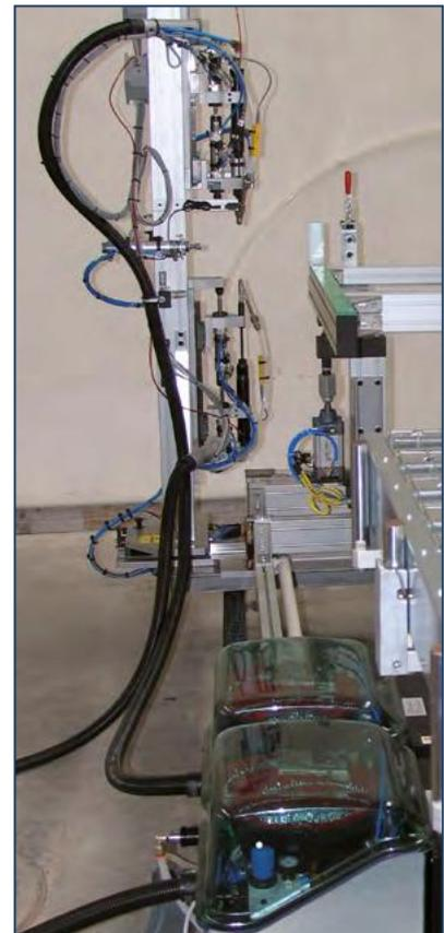
Mehrfach-MCA für den Rahmenbereich: gleichzeitige Montage von oben nach unten und von unten nach oben
