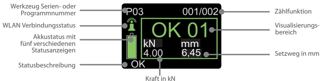
Das Display des RivBee® wurde so entwickelt, dass der Mitarbeiter intuitiv durch die Prozessschritte geleitet wird und zu jedem Zeitpunkt die Qualität der Nietverbindung ablesen kann.
