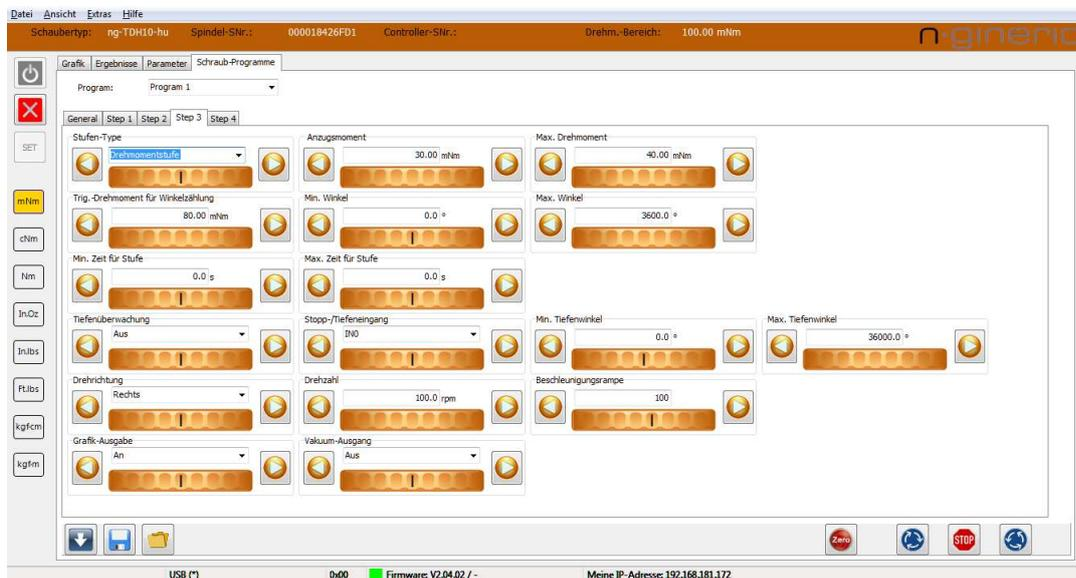
Die Drehmomentstufe gewährleistet eine hohe Prozesssicherheit, indem ein Drehmomentfenster, ein Zeitfenster, der Drehmomentgradient und optional die Einschraubtiefe überwacht werden können.
