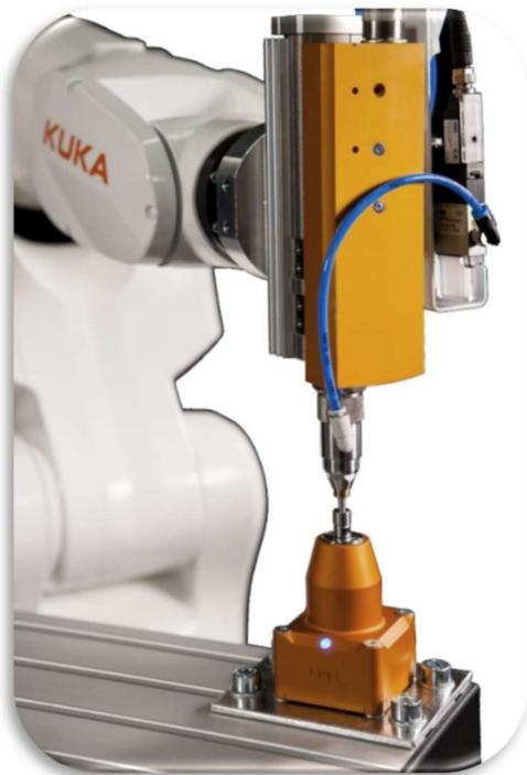
Drehmoment-Verifikation von Schraubsystemen
