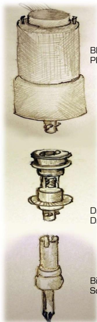
BL-DC-Motor mit Planetengetriebe
