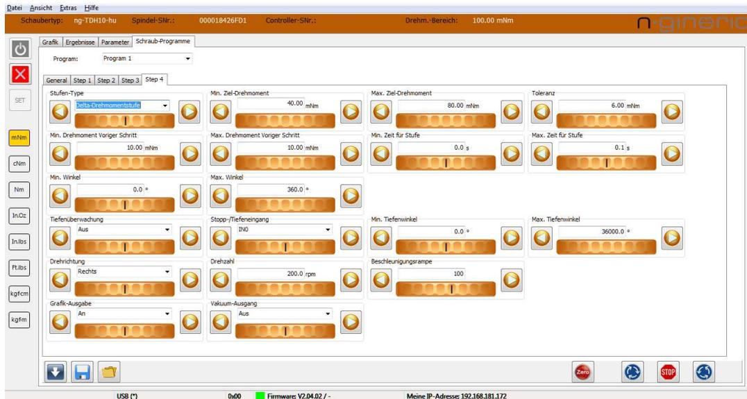
Die Delta-Drehmomentstufe ermöglicht es, nach Erkennen der Kopfauflage einen fixen oder variablen Betrag zusätzlichen Drehmoments in die Schraubverbindung einfließen zu lassen. Das Ziel ist hier, eine möglichst konstante Klemmkraft zu erreichen, auch wenn die Werkstücke Abweichungen des Drehmoments bis zur Kopfauflage aufweisen.
