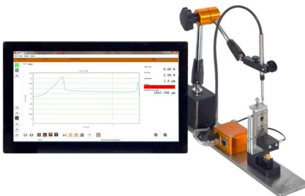
Kraft-/Weg-Mess-System zur Prüfung des Schaltpunkts von Drucktastern
