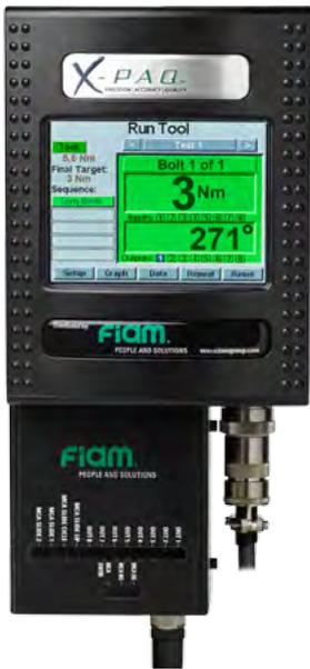
Die Elektronikmotoren X-PAQ werden mit dem Gerät CT2500 A kombiniert, das, neben der Stromversorgung des Motors auch die Funktionen **Programmierung und Steuerung jeder Phase des Verschraubungszyklus mit folgenden Merkmalen ausführt:**
