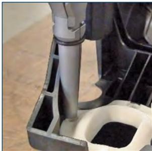
Die Halteköpfe sind das Ergebnis umfangreicher Erfahrung und werden als grundlegendes Element zum Erreichen einer Qualitätsverschraubung vollständig von Fiam entworfen und gebaut. Sie haben die Aufgabe, **die Schraube die von der Schraubenzuführung kommt, zu halten und richtig und sicher zu führen**, damit die Schrauben Klinge auf die Schraube aufsetzen kann, um den Verschraubungsvorgang am Stück fortzusetzen.
