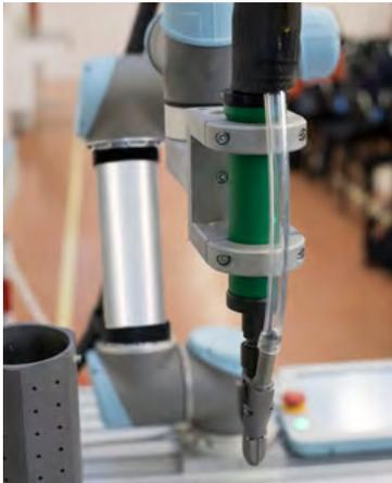
Eine Vorrichtung, die das automatische Vorschieben der Klinge an den Verschraubungspunkt vorsieht und sie nicht zurückfahren lässt. Außerdem stützt sich der Kopf des Schraubers beim Verschrauben nicht auf die Oberflächen und schützt sie vor jeglichem Kontakt.
