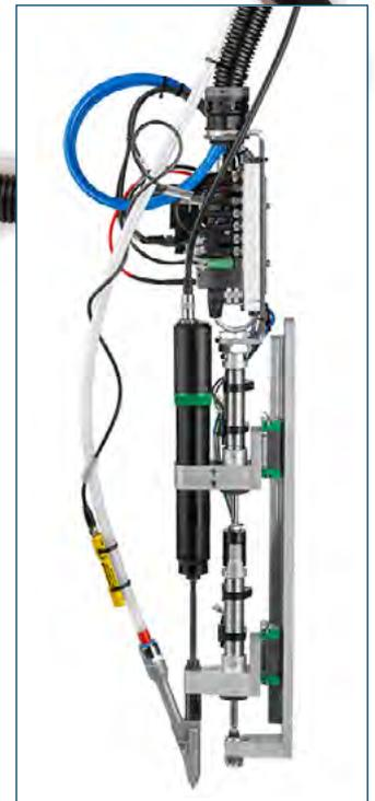
Schraubschlitten mit Elektroeinbauschrauber eTensil.
